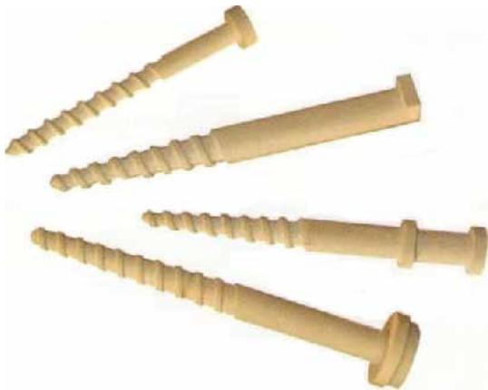
Керамические винты используются для крепления нагревательных элементов в различных электротермических тепловых агрегатах, футерованными модульными блоками из керамического волокна. Данные винты обладают высокой огнеупорностью, электроизоляционными свойствами, стойкостью к тепловому удару, длительным сроком службы.
